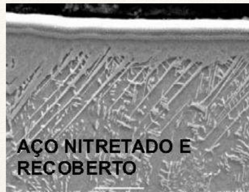
(a) Conjugado Monocamada (aço ABNT 1045 recoberto com Cr-N); (b) Conjugado “Dúplex” (aço nitretado a plasma mais recobrimento de Cr-N); MANCOSU, 2005.
