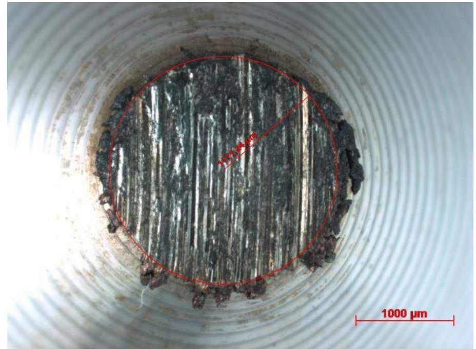
Exemplo da medição do raio na lupa estereoscópica após os ensaios.
