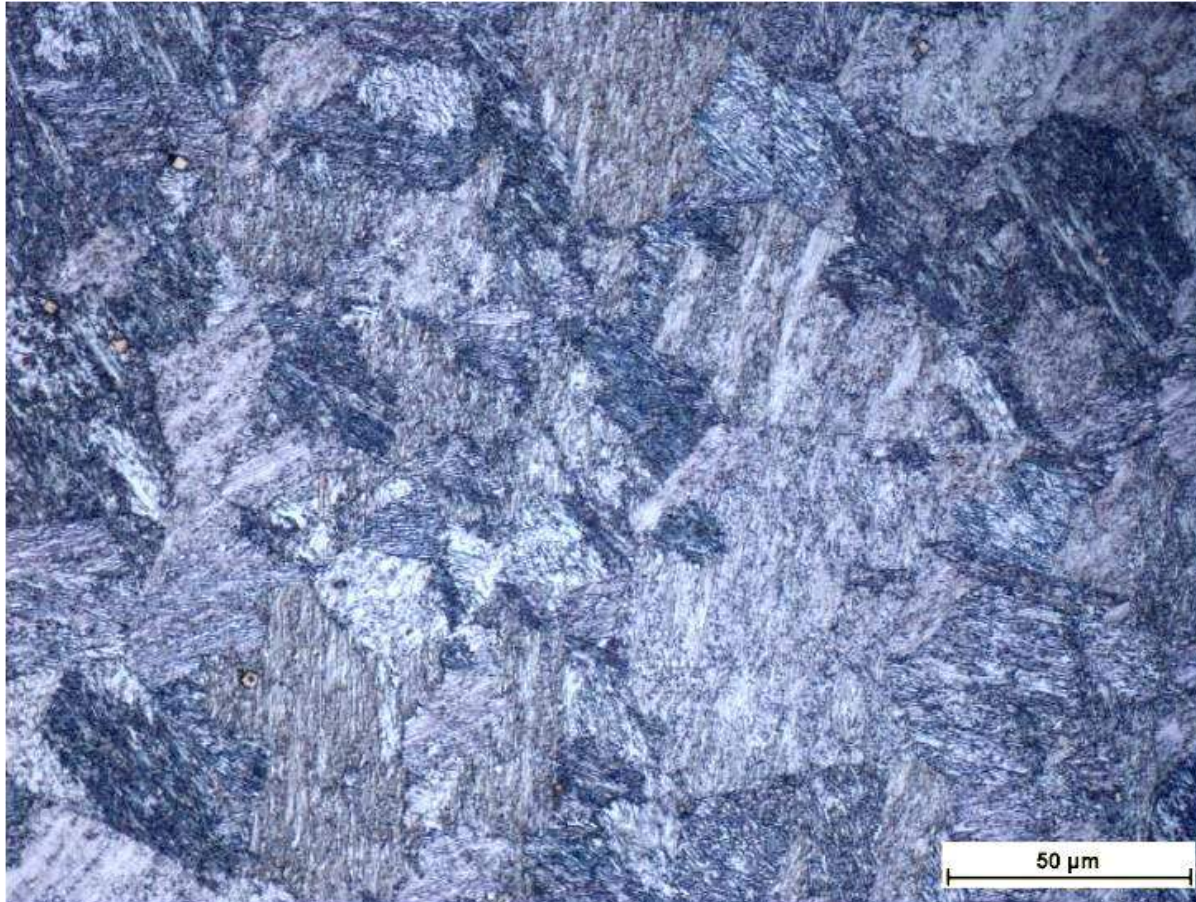
Microestrutura do material utilizado para fabricação do pino revelada através do ataque com solução de Vilella (magnitude original: 500x) – MO.
