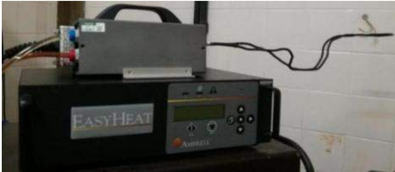
Aquecedor indutivo Easy Heat 0112 , da Ambrell , utilizado no aquecimento dos discos para os ensaios realizados a 500 °C.
