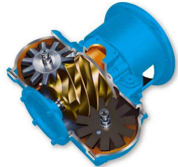
Fig. 3 - Compressor Z-screw. Fonte: Mitsui Seiki (2012).
