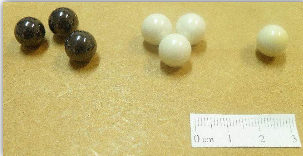
Fig. 12 - Esferas de \text{Si}_3\text{N}_4 (à esquerda), esferas de \text{ZrO}_2 (centro) e esfera de \text{Al}_2\text{O}_3 (à direita). Fonte: autor.
