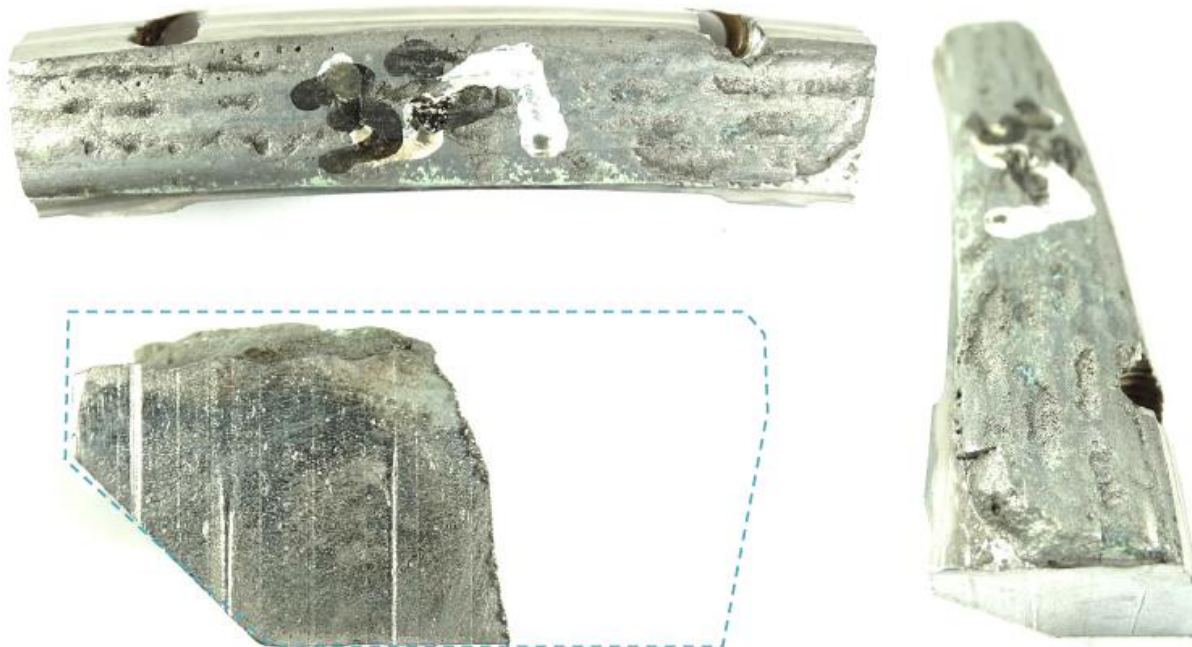
Aspecto de inserto após campanha de 9.200 km.
