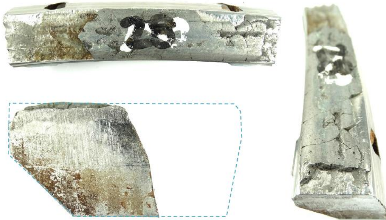
Aspecto de inserto após campanha de 9.200 km.
